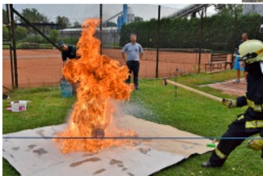
Nikoliv gulášová havárie, ale ukázka, co udělá hořící olej při hašení vodou
